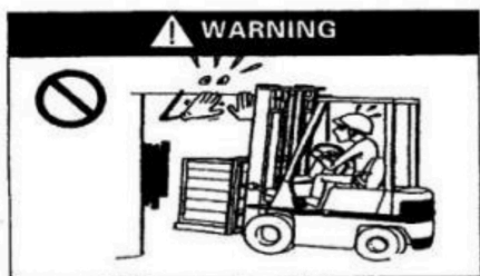
Comprobar siempre la altura libre en la zona de trabajo
