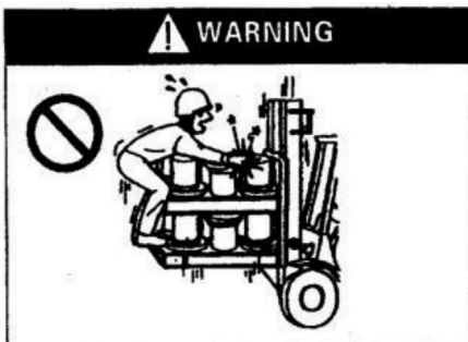
No permitir que nadie se suba a la carga.
