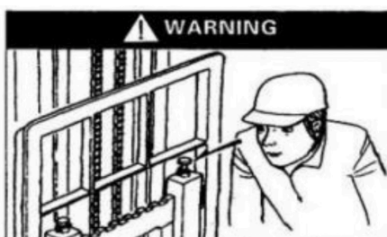
Comprobar que el pasador de bloqueo de las horquillas está correctamente fijado.
