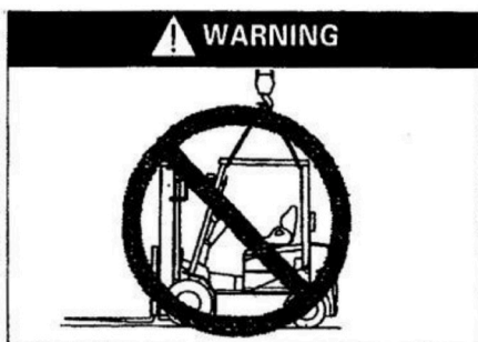
Prohibido izar la carretilla utilizando el techo protector.
